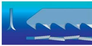
фрезерованные разведенные зубья
