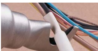
Монтаж термоусадочных трубок (только HG651C)
